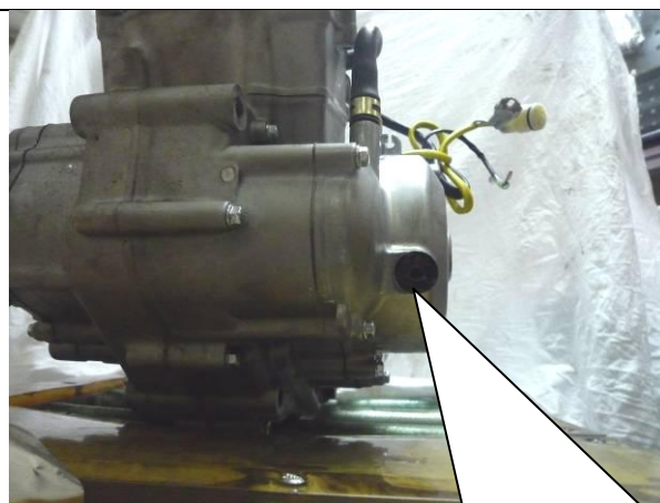
Болт крепежной планки оси коромысла NC250
